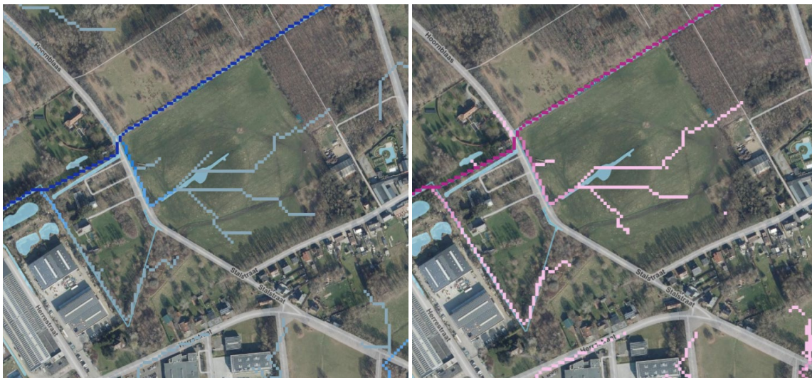
Figuur 36: Afstromingskaart (enkelvoudige stroomlijnen) (Geopunt) - links
