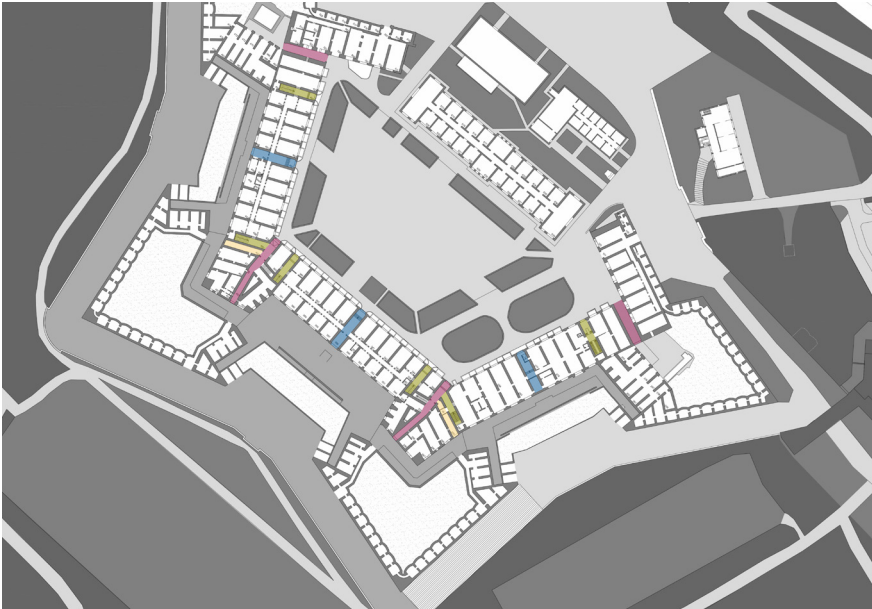
afb. 111: Aanduiding van de verschillende poternes met centrale poternes (blauw), hoekpoternes (roos),kleine zijdelingse poternes (geel), secundaire kelder poternes (mosterd) en secundaire wal poternes (grijs) © Citadel van Diest: militair bouwwerk doorgelicht. Plan bewerkt door Origin
