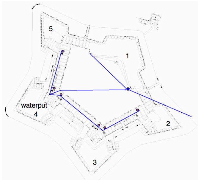
afb. 137: Schematische voorstelling van de verspreiding van het water vanuit de waterput © Citadel van Diest: militair bouwwerk doorgelicht. p 154
